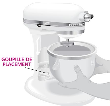
**REMARQUE :** Le bol réfrigérant est conçu pour s'adapter à tous les batteurs à bol relevable. Si l'ergot situé à l'arrière du bol est trop court ou trop long pour s'enclencher dans le loquet à ressort, retirez le bol et faites-le pivoter pour que l'ergot opposé soit en face du loquet à ressort. Répétez les étapes 3 et 4.
